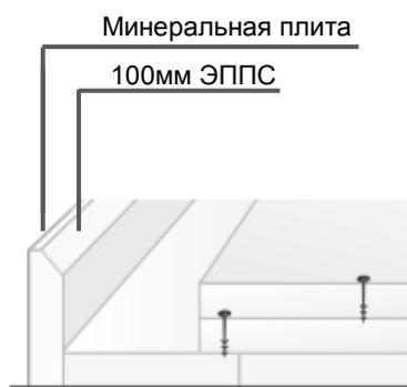
Thermogrund® является фундаментной системой для жилых домов, промышленных зданий и других крупных строений. Система состоит из высококачественно теплоизолированной бетонной плиты со встроенной системой теплых полов. Фундаментная система сохраняет грунт основания сухим, а легкие блоки позволяют в кратчайшие сроки построить свою систему Thermogrund®.
