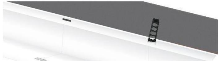
Нижнюю часть плит и блоков соедините зубчатыми (гвоздевыми) пластинами.
